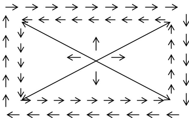
Внешний периметр тренажера-рисунка нанесен красными стрелками. Длина и ширина их подбирается произвольно, но расстояние между ними мы рекомендуем в 20 см, не более. Размеры прямоугольника могут быть 150 x 290-320 см. Нужно выдержать примерное соотношение сторон 1:2. Направление стрелок красного цвета по часовой стрелке.
